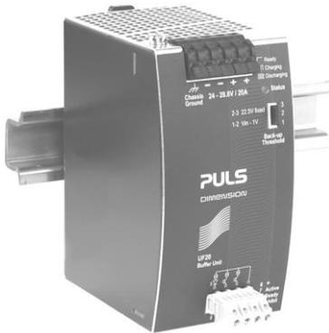
Für das Puffermodul ist keine Steuerverdrahtung erforderlich. Es kann an jedem beliebigem Punkt parallel zum Laststromkreis hinzugefügt werden. Puffereinheiten können parallel hinzugefügt werden, um zusätzlich mehr Strom zur Verfügung zu stellen oder die Netzausfall-Überbrückungszeit zu erhöhen.
